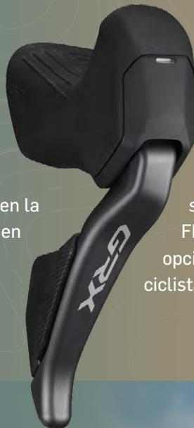
manillares con apertura, al tiempo que conserva la ubicación del tercer botón específico para gravel. Para completar el cockpit, las manillas RX825 son compatibles con tres opciones de cambio satélite e incorporan la función SHIMANO FRONT SHIFT NEXT para maximizar las opciones de personalización por parte del ciclista.
